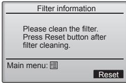
Filtre işaretini yeniden ayarlamak için [F4] düğmesine basın. Filtrenin nasıl temizleneceği hakkında bilgi almak için iç ünitenin Kullanım Kılavuzuna bakın.
